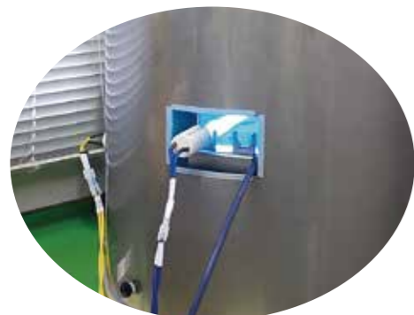
除菌ユニット内のUVランプ点灯試験 (実際のユニットでは、窓は完全に遮蔽されます)
